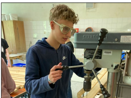
5 Junis bohrt die Latten vor
