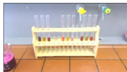
Farbstoffe (aus Rote Beete, Himbeeren und Heidelbeeren) in Abhängigkeit vom pH-Wert (von links nach rechts: sauer, alkalisch und neutral)
